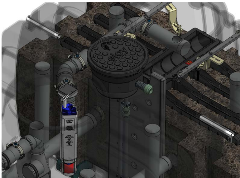
Fig-21 : préfiltre lamellaire n° 1 - assurez-vous que le préfiltre est totalement emboîté jusqu'en butée et que la poignée est correctement installée. Continuité aéraulique externe.
