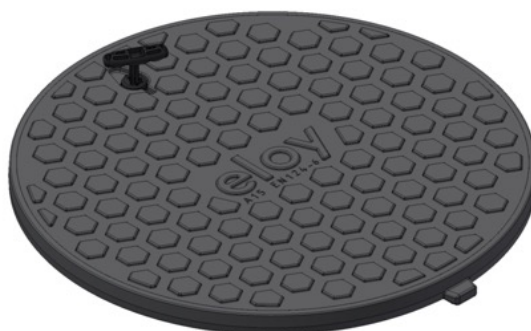
Fig-9 : couvercles polyéthylène (x2) Ø ext. 705 mm A15 EN 124-6 pour les accès à la fosse toutes eaux et au filtre des Bio/x-perco® R90 flex
