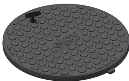
Fig-6 : couvercles polyéthylène (X2) Ø ext. 705 mm A15 EN 124-6 pour les accès à la fosse toutes eaux et au filtre
