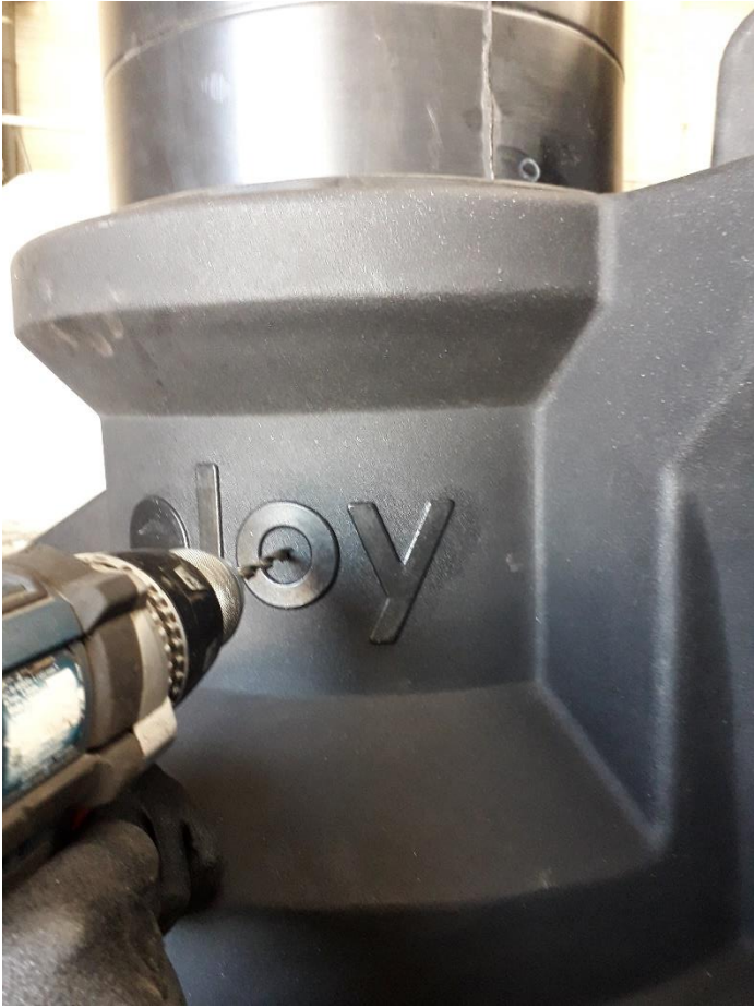
Fig.18 – percement de la rehausse
