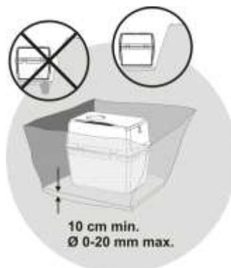
Figure 8-4: **Mise en fouille**
