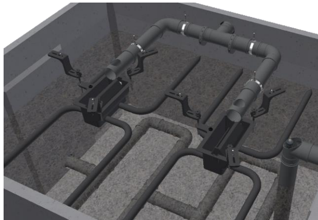
Fig-8 : Dispositif de répartition dans une cuve de traitement
