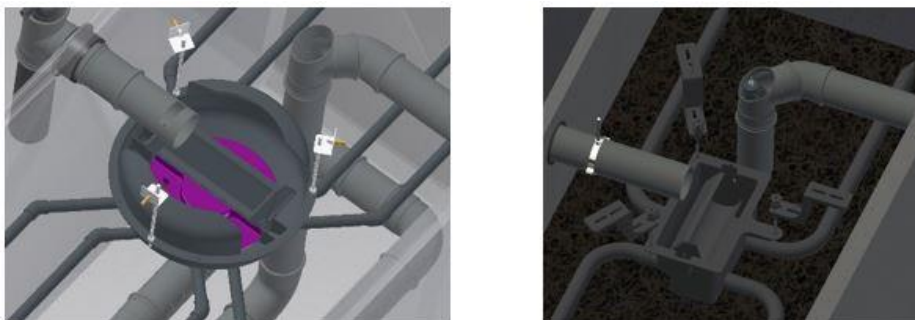
Fig-36 : Auget basculant (à gauche) et basculeur rotatif (à droite)
