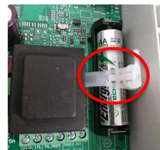
4. Extraire la pile, et la remplacer par une neuve **identique**.
