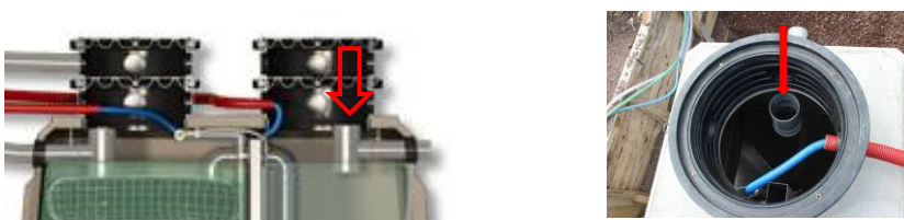
Fig 5a : Té d'échantillonnage dans une station Oxyfix® 27EH
