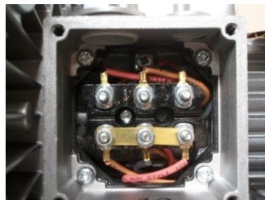
Fig-21 : montage «Étoile» 3 x 380V Y
